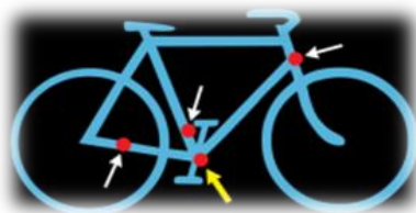
Рисунок 2 – Схематичне зображення місць розташування серійного номеру велосипеда
